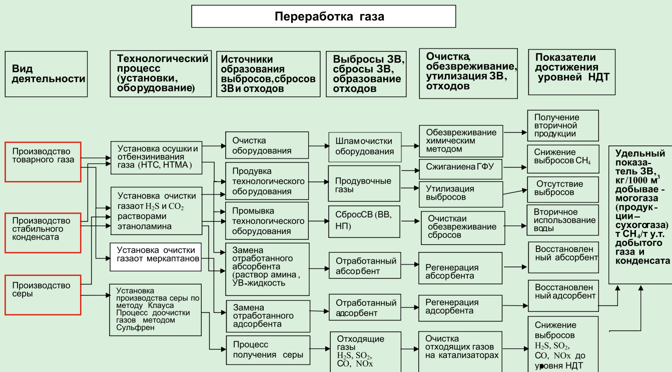
РИСУНОК 1 – ФРАГМЕНТ СХЕМЫ ФОРМИРОВАНИЯ СВЕДЕНИЙ О НДТ В ПЕРЕРАБОТКЕ УГЛЕВОДОРОДНОГО СЫРЬЯ ОАО «ГАЗПРОМ»
